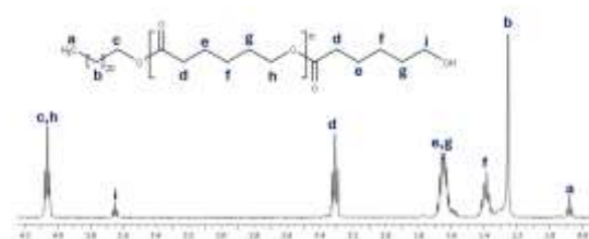
Figura 4. Espectro RMN- 1 H (500MHz) de poli( \epsilon -caprolactona) catalizada por L-Isoleucina a 4 horas de reacción.
